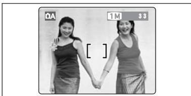
在这种取景构图中，拍摄对象(如此例中的两个人)不在AF(自动对焦)框内。如果此时进行拍摄，拍摄对象将不会被对焦。
